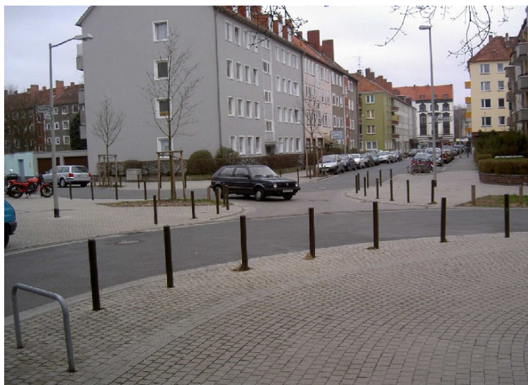
Obrázek 6 - Příklad umístění zvýrazňujících sloupků
